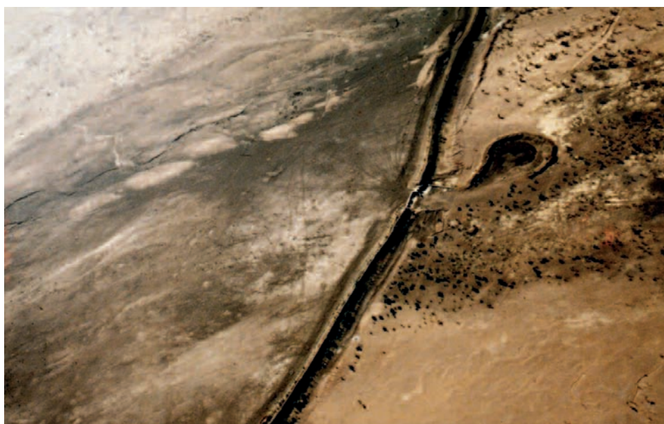
Photo 2: Vue aérienne d'un barrage de décrue à l'aval duquel on a réalisé un bouli pour récupérer par dérivation une partie des eaux de vidange. Il doit être implanté à quelques dizaines de mètres au moins en aval du barrage afin d'éviter de favoriser la remontée d'une nappe interne au remblai qui pourrait être préjudiciable à sa stabilité. En outre, cette distance est nécessaire pour permettre un contrôle aisé des fuites éventuelles au pied du talus aval du barrage
